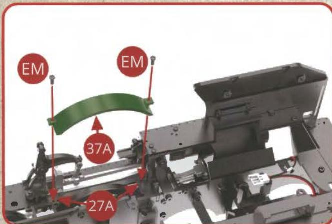
Présentez le premier couvre-roue gauche 37A sur le dessus du tablier gauche 27A et assemblez-le avec deux vis EM.
