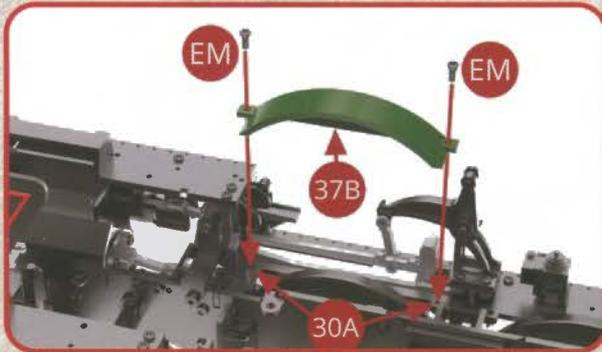
Présentez le premier couvre-roue droit 37B sur le dessus du tablier droit 30A et assemblez-le avec deux vis EM.
