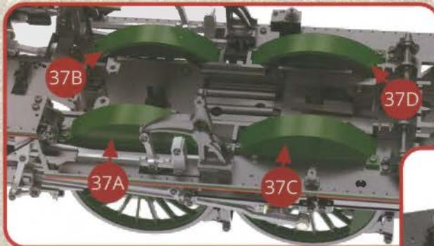
Deux couvre-roues du côté droit et deux couvre-roues du côté gauche sont en place sur le tablier du châssis.
