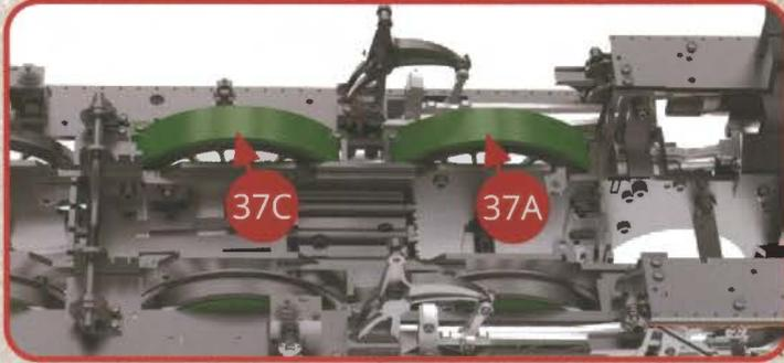
Les deux couvre-roues du côté gauche sont en place sur le tablier du châssis.
