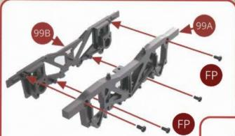
Positionnez le flanc extérieur de bogie 99A sur le flanc intérieur de bogie 99B et assemblez-les avec quatre vis FP.
