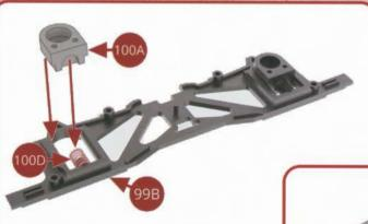
Rétournez sur lui-même le flanc intérieur de bogie 99B, positionnez le palier de boîte d'essieu 100 B sur la face extérieure de boîte d'essieu 100A et assemblez-les avec deux vis AP. Positionnez le ressort de suspension 100D dans le flanc de bogie intérieur droit 99B. Positionnez la face extérieure de boîte d'essieu 100A sur le flanc de bogie intérieur droit 99B en y engageant le ressort de suspension 99F.
