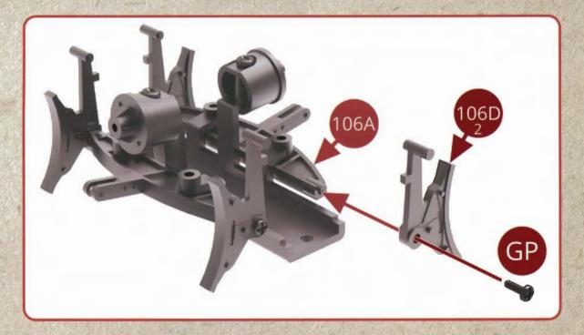
Positionnez le sabot droit 106D (2) à l'extrémité droite du triangle de frein 106A et assemblez-le avec une vis GP.
