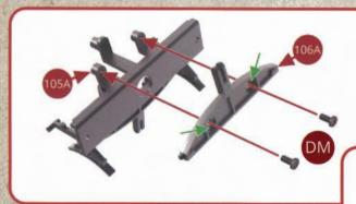
Positionnez le cylindre à air comprimé 106B sur la traverse du bogie 105A et assemblez-le avec une vis DM.
