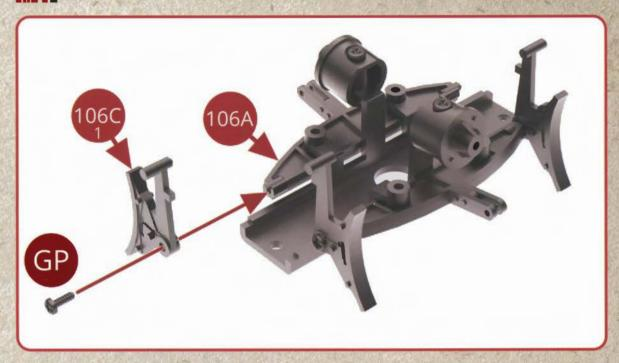
Positionnez le sabot gauche 106C (1) à l'extrémité gauche du triangle de frein 106A et assemblez-le avec une vis GP.
