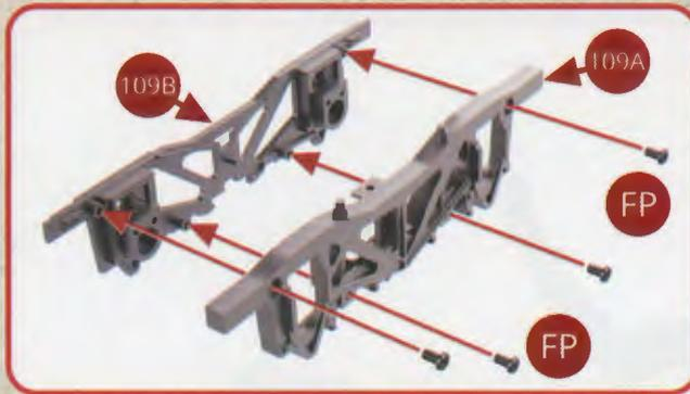
Positionnez le flanc de bogie extérieur gauche 109A sur le flanc intérieur droit 109B et assemblez-les avec quatre vis FP.
